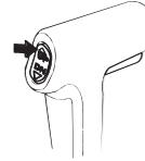
Con il motore fuoribordo con assetto basso, il misuratore di assetto appare come segue. Per sollevare la prua, aumentare l'angolo di assetto premendo UP sull'interruttore assetto/inclinazione elettriche.
