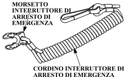
Il cordino per l'interruttore per l'arresto di emergenza è fornito per arrestare immediatamente il motore quando l'operatore cade fuori bordo o è lontano dal motore fuoribordo.
