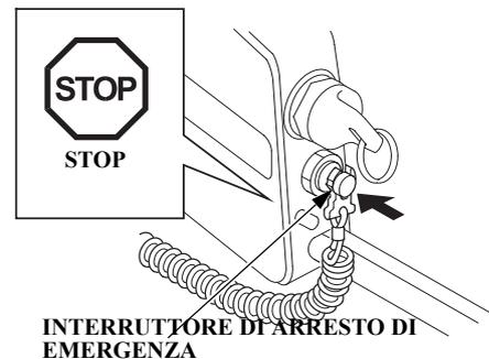
Premere l'interruttore per l'arresto di emergenza per arrestare il motore.
