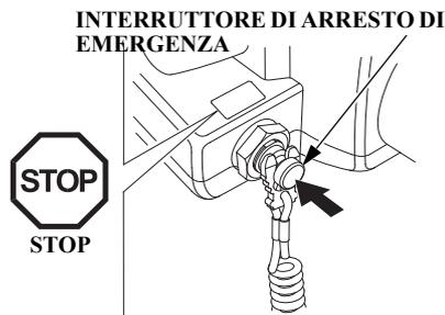
Premere l'interruttore per l'arresto di emergenza per arrestare il motore.
