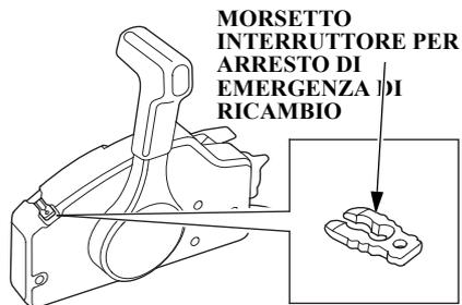
Un morsetto dell'interruttore per l'arresto di emergenza è fornito sulla scatola di comando a distanza.
