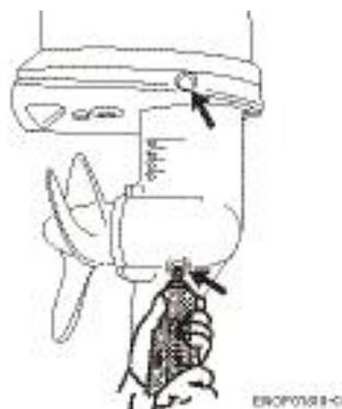
4. Posizionare il tappo superiore dell'olio e poi rimuovere la bocchetta del tubo dell'olio e posizionare il tappo dell'olio inferiore.
