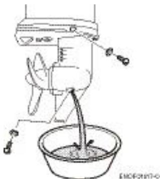
3. Inserire la bocchetta del tubo dell'olio nell'orifizio del tappo dell'olio inferiore, e riempirlo con l'olio per ingranaggi stringendo il tubo d'olio fino a quando esce olio dall'orifizio del tappo superiore e le bolle sono scomparse per eliminare l'aria.
